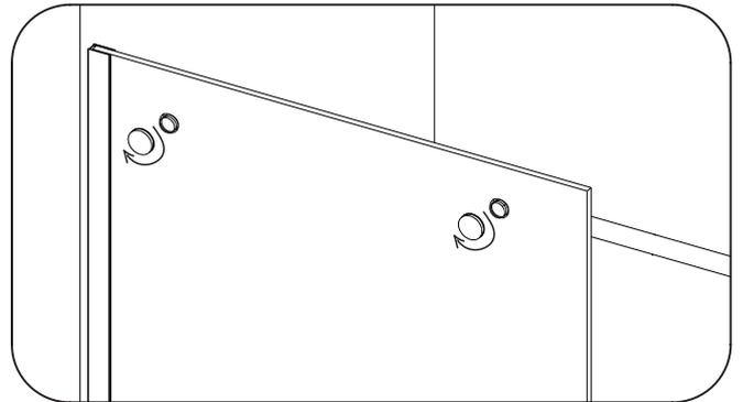
3.5. Assurez-vous que la **vitre fixe** et le **rail de guidage supérieur** sont de niveau. Si un réglage horizontal est nécessaire, ajustez-le à l'aide des supports de vitre. Glissez le **support du rail de guidage** contre le mur et marquez sa position. Placez le support mural à la position indiquée et tracez les trous de perçage dans le mur.
