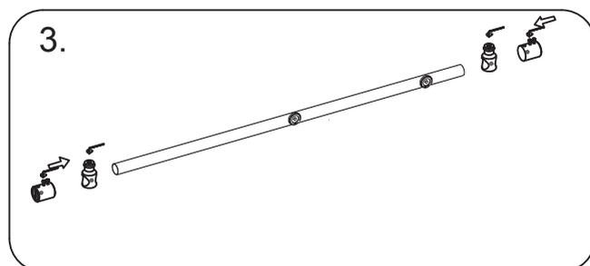
3.4. Une fois l'installation du rail de guidage terminée, verrouillez le côté avant du support de verre pour verrouiller le verre fixe sur le rail de guidage.
