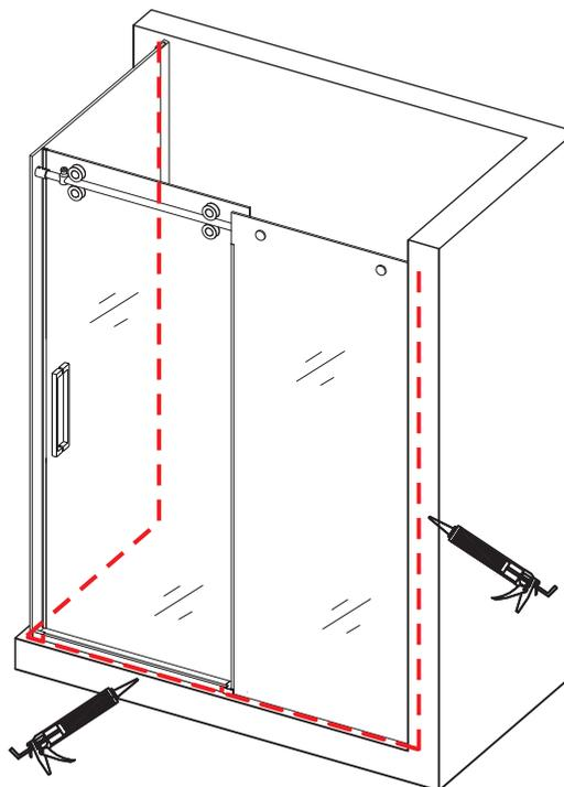
8.1. Appliquez le mastic sur les joints entre la bande inférieure et la baignoire de douche ; et entre le verre fixe et le mur.
