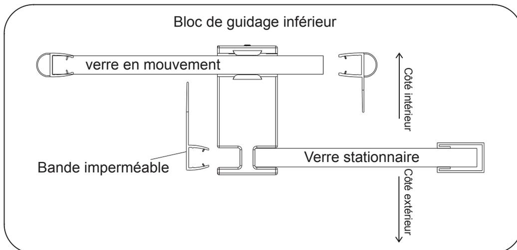
5.1. Installez les deux roulettes inférieures. Ajustez maintenant la vitre à la verticale, puis installez les deux roulettes inférieures.
