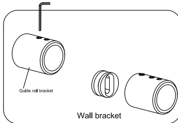
3.2. Utilisez la clé Allen pour desserrer la vis du support du rail de guidage et de la butée de porte en verre. Faites glisser temporairement la butée, puis le support sur le rail de guidage.
