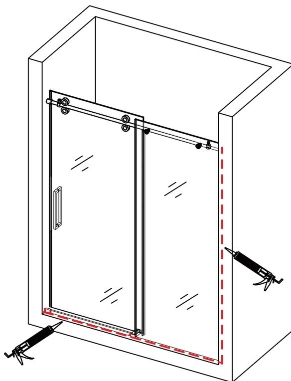
8.1. Appliquez le mastic sur les joints entre la bande d'étanchéité inférieure et la baignoire de douche; et entre le verre fixe et le mur.
