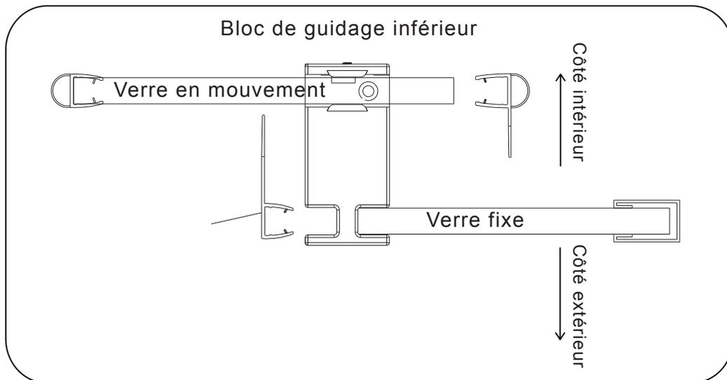
5.1. Installez les deux rouleaux inférieurs. Ajustez maintenant la vitre à la verticale, puis installez les deux roulettes inférieures.
