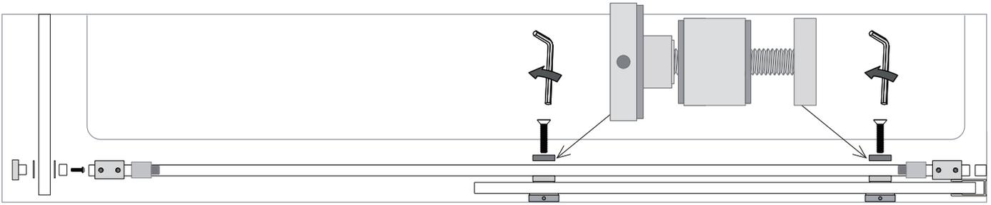
Installez d'abord le bloc anti-collision sur le rail de guidage, puis verrouillez fermement le rail de guidage et la base murale.
