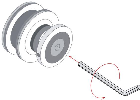
Démonter la poulie et l'installer sur la vitre
